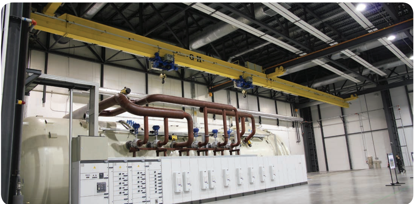
JEDNODŹWIGAROWA SUWNICA PODWIESZANA Z KILKOMA PUNKTAMI PODNOSZENIA. Udźwig do 20+20t.
